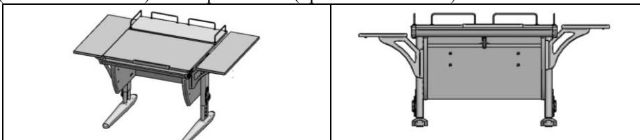
5.1. В полку (поз. 1) снизу прикрутить кронштейны (поз. 2) с помощью саморезов с прессшайбами (поз. 1 пакет № 20), см. рис. 1.
